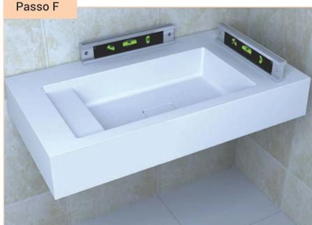
Com o auxílio de um nível, **nivele o lavatório** nas duas posições indicadas na foto. Após nivelado, realize um aperto final nas porcas (item 5).
